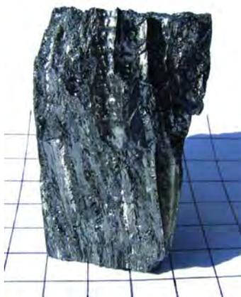
Beryllium, kristallines Bruchstück. Meßgeräte zur Bestimmung der Newtonschen Gravitationskonstanten sollten aus Beryllium oder einer Beryllium/Aluminium-Legierung angefertigt werden.
